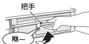
※ 真空泵啟動後至達到真空狀態、約需3 ~ 4分鐘。在4分鐘以內打開真空保鮮箱，有可能沒有“啾—”的聲音。
